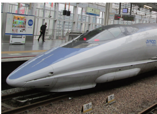
(図1)カワセミのくちばしを模した500系新幹線の先頭形状
